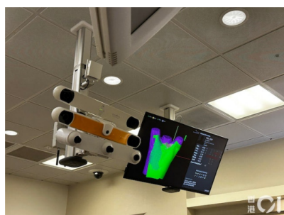
新系統配合3D攝影掃描，可協助畫身標度與位置，對準治療位置及精準腫瘤，大幅減少電療對周圍健康組織的傷害及副作用。（陳淑霞攝）
